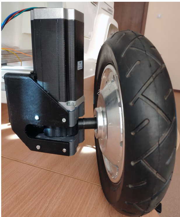
Рис. 2. Второй вариант инновационного блока колёса (а) и детализовка его конструкции (б).
