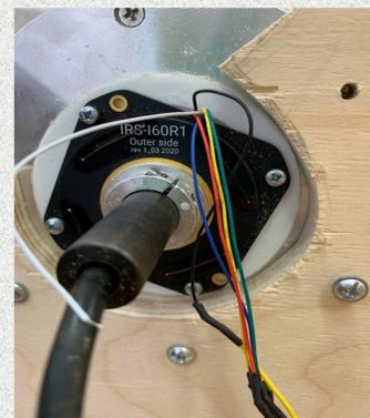
Рис.5. Энкодер мотор-колеса.
