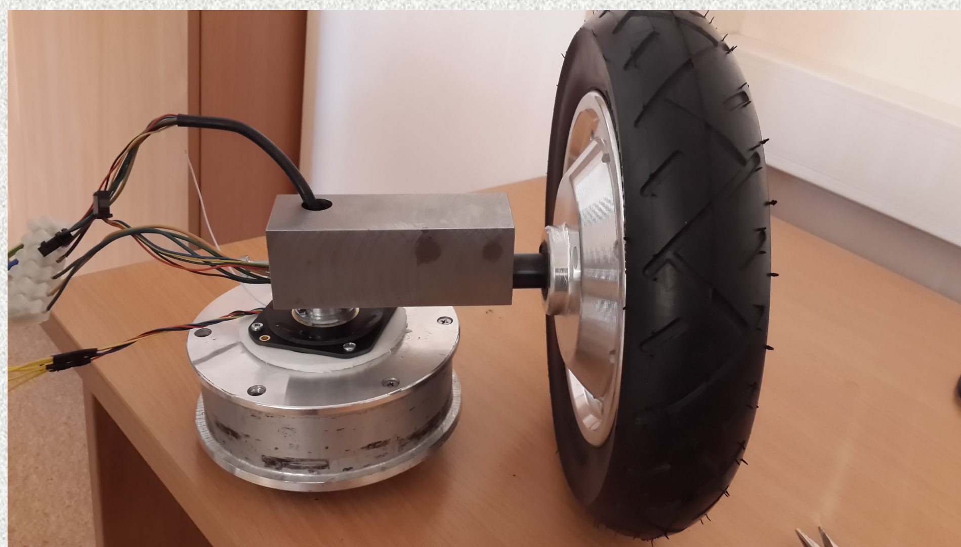
Рис. 4. Первоначальный вариант привода поворота колеса, предложенный в «ЦО»Кудрово»
