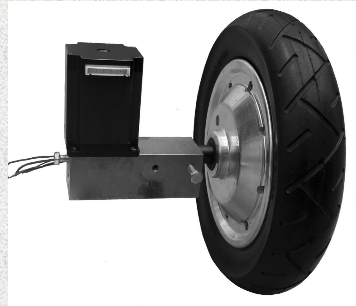
Рис. 4. Конструкция инновационного блока колёс
