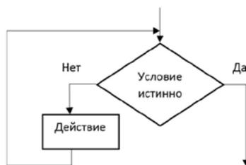
**Рис. 109.** Блок-схема цикла
