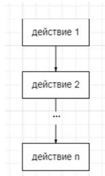
**Рис. 84.** Блок-схема линейного алгоритма
