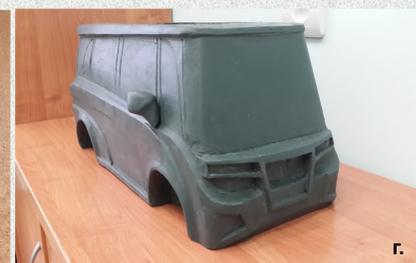
Рис. 6. Этапы апробации инновационного способа: а. распечатка фрагментов и сборка; б. запенивание; в. готовая основа для пластилинового макета; г. пластилиновый макет на формозадающей основе, выполненной инновационным способом.
